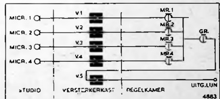
Fig. 1. Vereenvoudigd blokschema voor een studio-installatie met 4 microfoon-ingangen.
